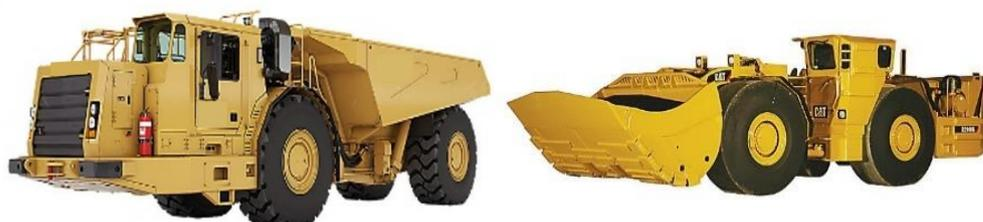
图 井下矿用轮胎适用车辆示意图
