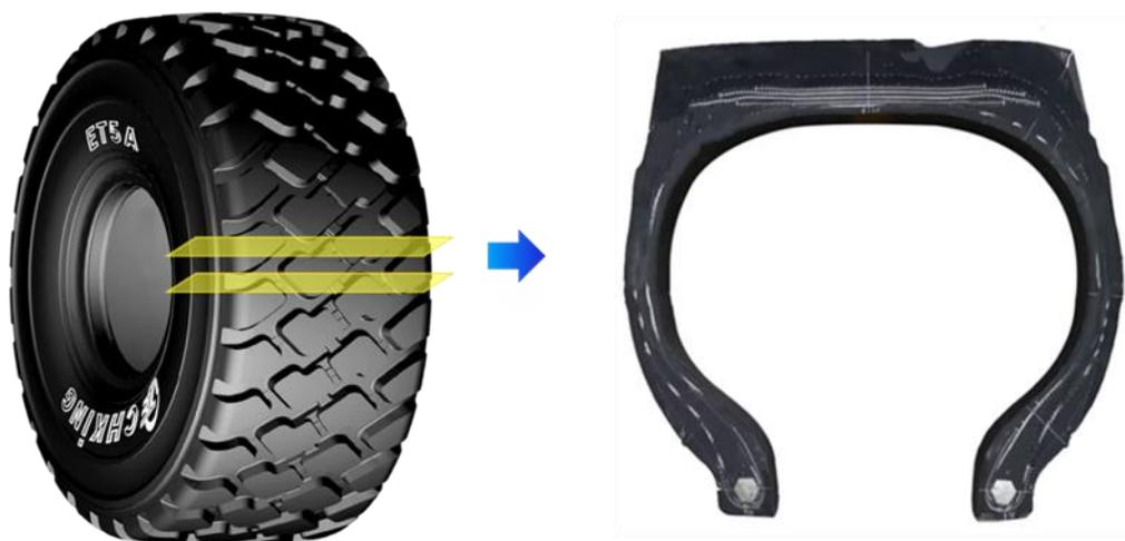
图 试制断面图
