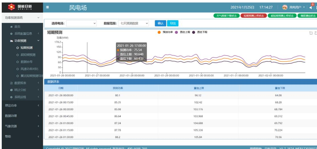
如前述拓扑图所示,短期发电功率预测数据在后台数据中心计算完成后,公司将这一数据与高精度气象预测数据一起通过电站功率预测系统的数据中转服务器,经反向隔离装置等传输至电站工作站,并由工作站将数据传输至电网调度系统。
