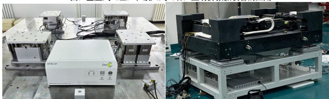
图：基座式（左）和嵌入式（右）主动防微振设备的应用
