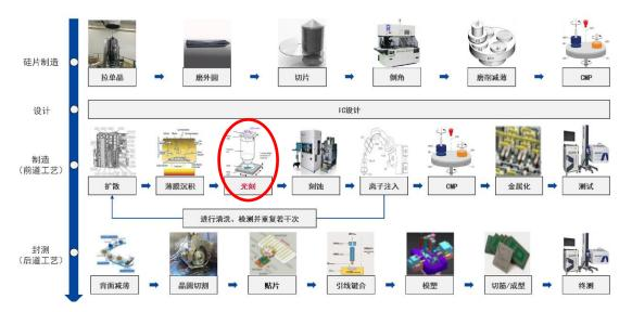
工艺制程指半导体制造中晶体管达到特定物理尺寸所对应的技术工艺,目前一般用多少 nm 制程或者多少 nm 制程节点来表示。一般这个制程节点的数字越小,晶体管的尺寸也越小,代表技术水平越先进,精度越高,对应的工艺难度就越大。目前而言,"多少 nm"制程只是代表着制程的迭代,每代工艺都使芯片上的晶体管数量增加一倍。
