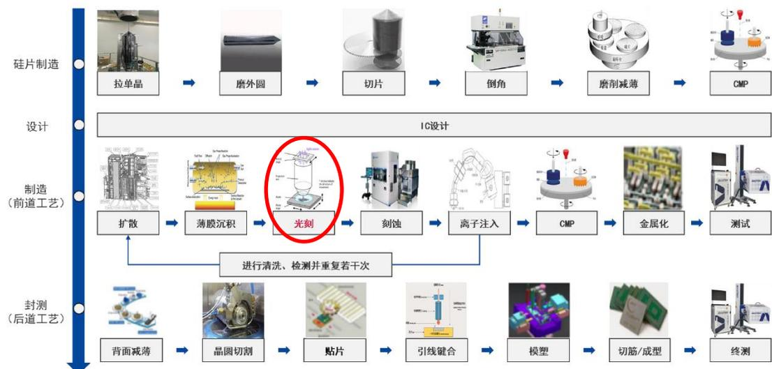
工艺制程指半导体制造中晶体管达到特定物理尺寸所对应的技术工艺，目前一般用多少 nm 制程或者多少 nm 制程节点来表示。一般这个制程节点的数字越小，晶体管的尺寸也越小，代表技术水平越先进，精度越高，对应的工艺难度就越大。目前而言，“多少 nm”制程只是代表着制程的迭代，每代工艺都使芯片上的晶体管数量增加一倍。
