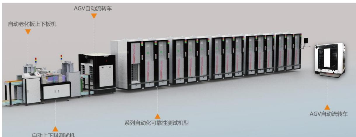
图 BTR-T660A 产线设备整体布局
