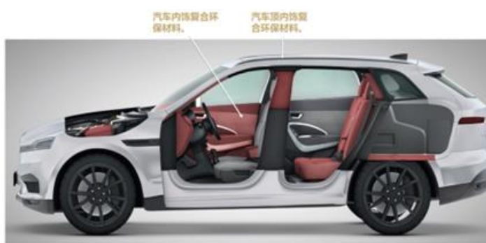
热熔胶网膜、胶膜应用于汽车内饰
