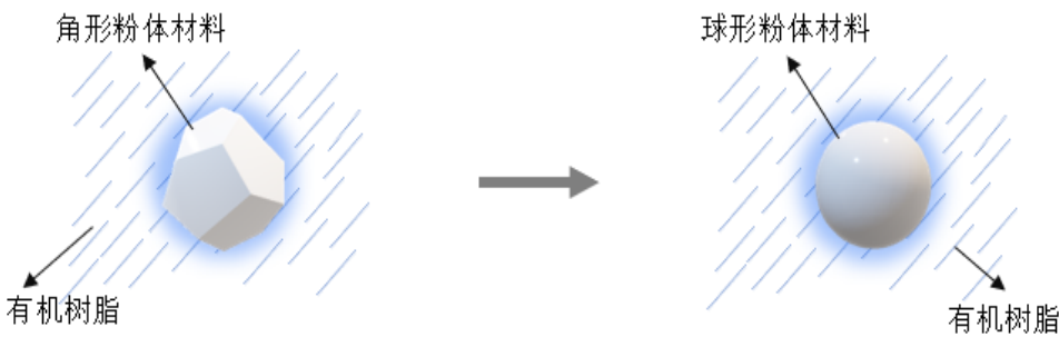
相同体积下，球形粉体表面积更小，与有机树脂接触面更小
