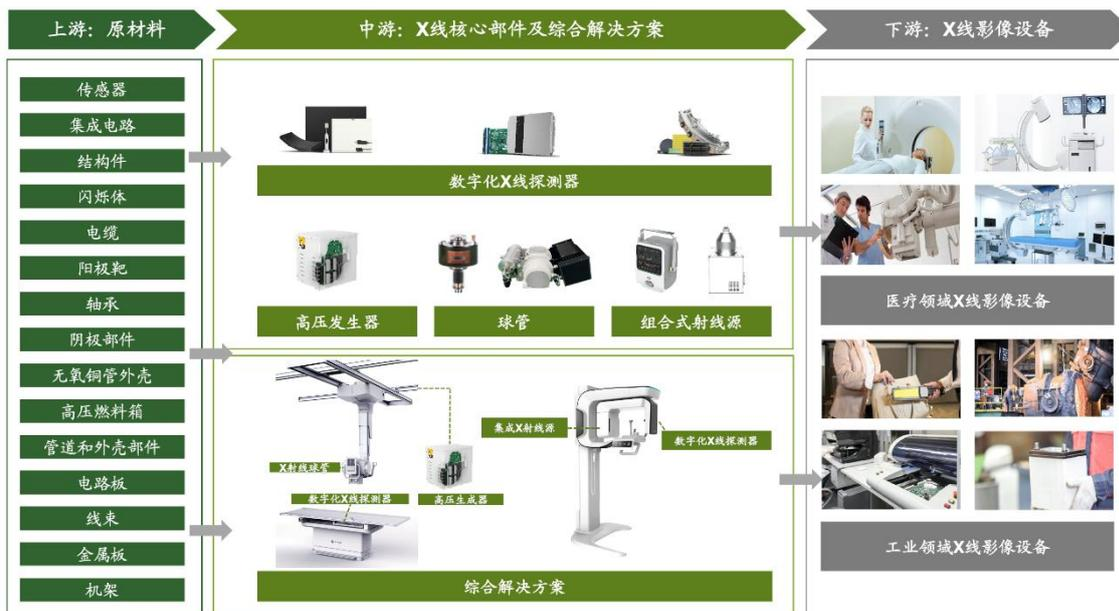
产业链的上游为 X 线核心部件的原材料，其中各 X 线核心部件的核心原材料具有较高的技术壁垒，对 X 线核心部件的性能、质量、产业化都有着重要影响。数字化 X 线探测器的原材料主要包括传感器、芯片、闪烁体、结构件和电缆；高压发生器的原材料主要包括高压燃料箱、外壳部件、电路板、线束和金属板；球管的原材料主要包括阳极靶材、轴承、阴极部件和无氧铜管壳等。X 线核心部件制造商需要与上游供应商保持紧密关系，或增强其上游整合及自主可控能力，以确保原材料的稳定供应。
