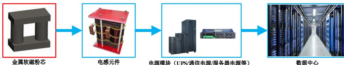
公司金属软磁粉芯产品在数据中心领域主要应用于不间断电源（UPS）、通讯电源和服务器电源中。
