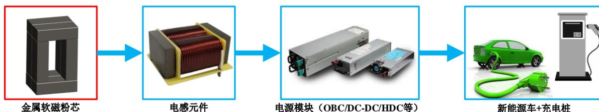
公司的金属软磁粉芯产品在新能源汽车领域主要应用在车载 OBC、DC-DC 等电源模块中，同时可应用在作为新能源汽车配套设备的充电桩中。
