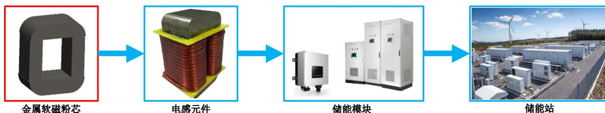
公司的金属软磁粉芯产品在储能领域主要应用在储能模块（充放电及逆变模块）电源中。
