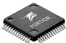
我們的MCU產品採用獨特的「雙核」架構，可優化BLDC電機驅動控制應用的性能與效率。我們自主開發的ME內核專注於複雜的電機驅動控制任務，而以8051或Risc-V架構為基礎的通用內核則處理外部通訊功能等輔助任務。這種分工可確保複雜的電機驅動控制運作不會消耗過多的運算能力，從而使電機主控芯片在處理電機驅動控制和其他輔助任務時，都能維持最佳性能。有關我們自主ME內核以及其與業界其他MCU公司普遍應用的ARM Cortex-M內核的比較詳情，請參閱本節「我們的核心技術優勢－芯片設計－我們的MCU芯片設計與其他常用芯片設計的比較」。MCU支持多種電機驅動模式，包括有感和無感控制、方波、正弦波和FOC模式。
