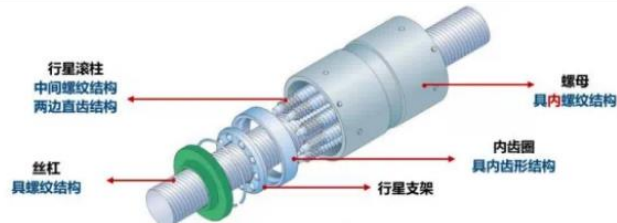
行星滚柱丝杠及相关构造拆解
