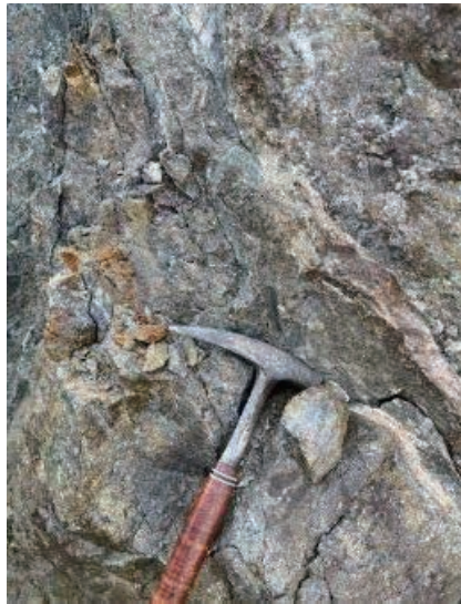
圖8-4：侵入岩中的熱液金銅礦礦化帶
