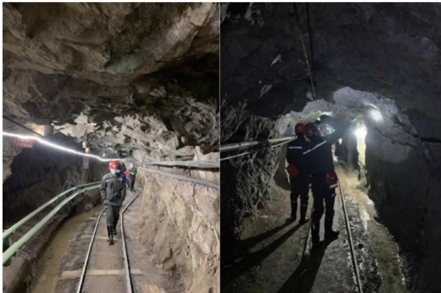
圖10-7：蓮花山5號採區典型水平平巷及橫切平巷照片
