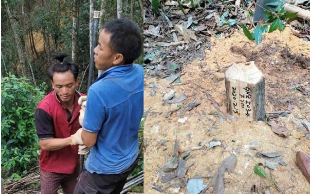
圖7-3：GN螺旋鑽的利用及封孔
