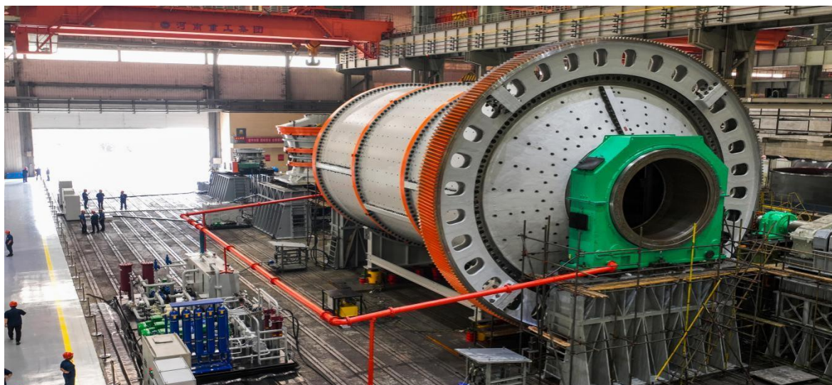
图示：研制的国产最大规格直径 8.2*12.7m 溢流型球磨机
