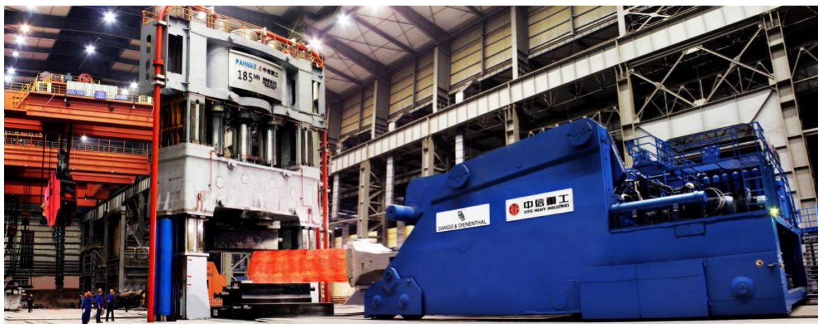
图示：中信重工构建的以 18500 吨自由锻造油压机组为核心的制造工艺体系
