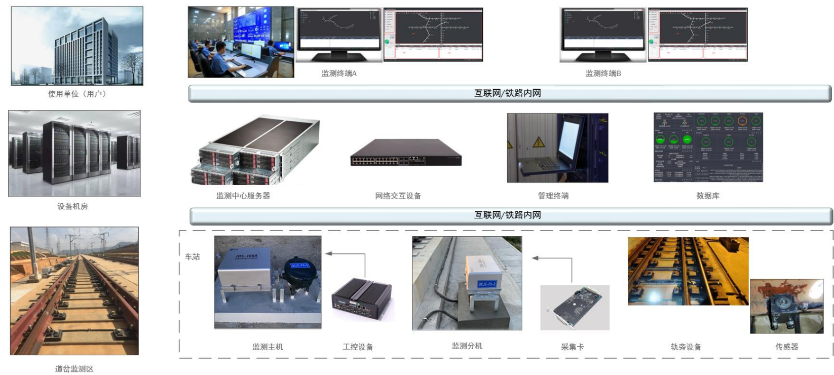
图 2：道岔监测系统网络架构图
