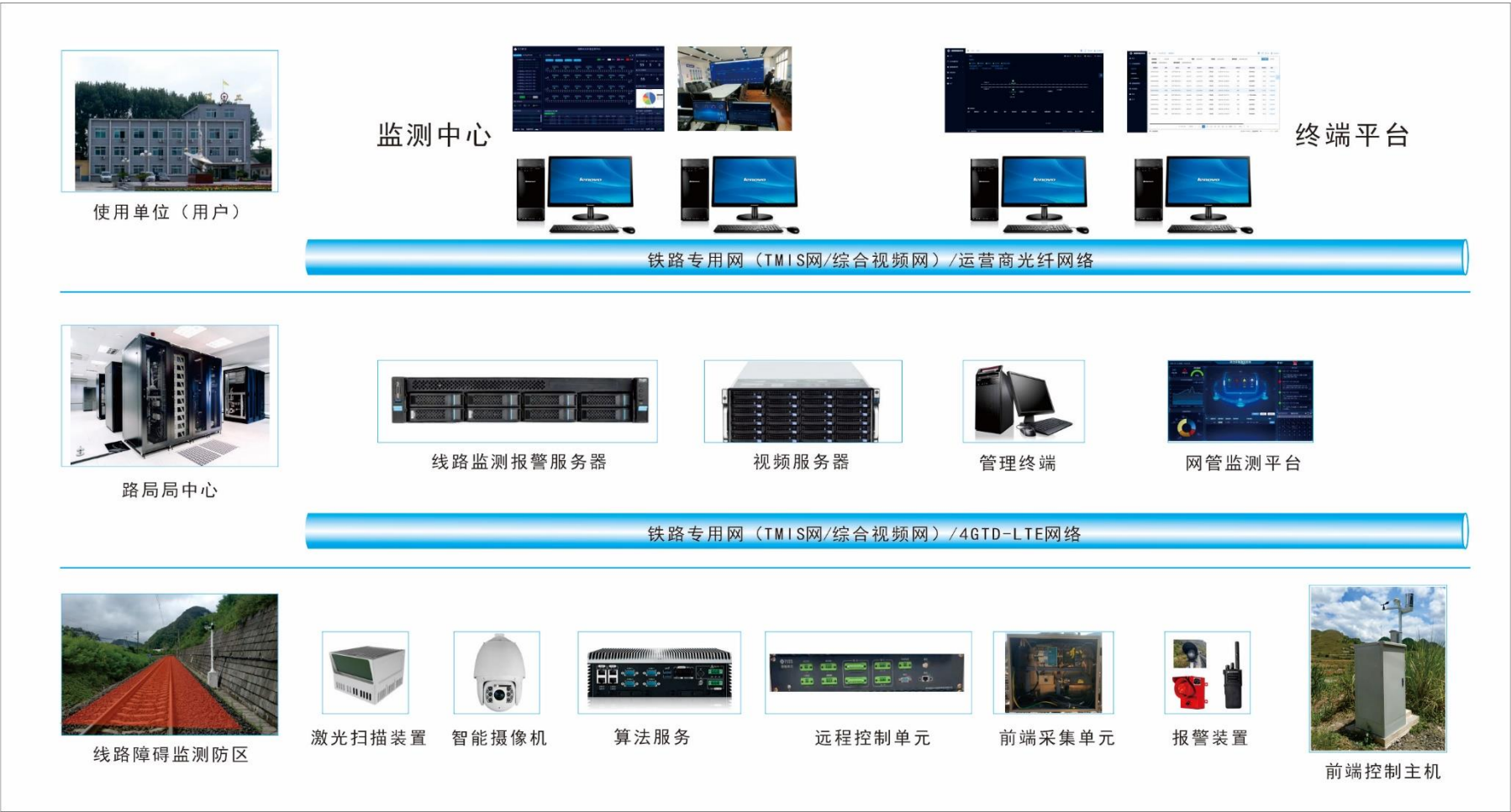
图 2.线路监测系统监测设备网络架构图 1
