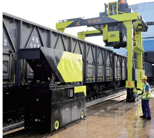
田庄选煤厂余煤回收智能清车机器人，智能清车机器人的单节原煤车厢余煤清扫率达95%
