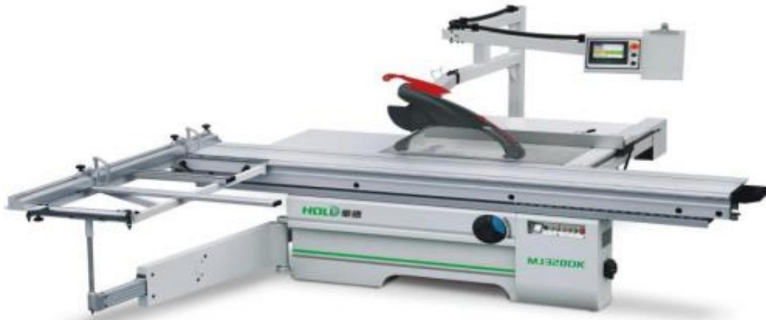
精密推台锯是家具生产中将板材进行精准裁切的智能化开料设备，具有高效、精密、安全和操作简单等优点。公司生产的精密推台锯采用双锯片装置，小锯负责划线，大锯负责开板，以保证板材不会产生崩边毛刺等现象。同时，通过在推台锯上加装欧式大尺寸靠尺，公司生产的精密推台锯有效保证了板材切割过程中的稳定性和精密度，以解决板材在裁切过程中的移位问题。
