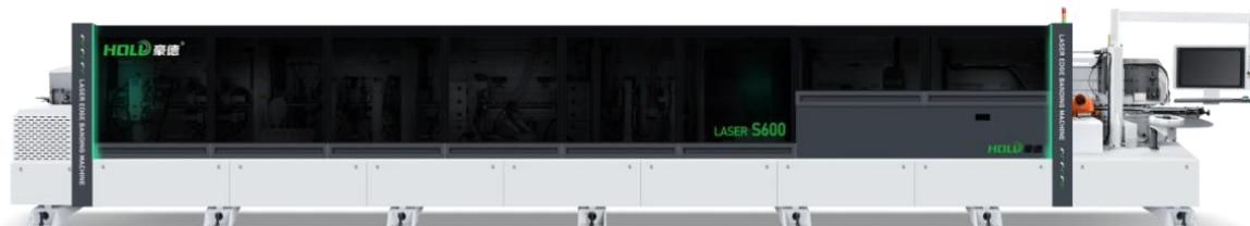
公司研发的激光封边机，利用激光装置代替原有的涂胶装置，在封边带与工件接触之前快速将封边带功能层激活熔化，通过压轮组将封边带压贴到工件上实现激光封边。与传统封边机相比，激光封边机无需胶水，就能实现无缝封边，避免了胶黏剂的挥发污染，具有无胶线、密封性高、粘合性强等特点，可满足高端橱柜、卫浴柜等对于防水、耐高温以及环保的需求。同时，公司研发的激光封边机能完美兼容 ABS、PP、亚克力等各种带有功能层的激光封边带，且开机即用，无需加热等待，可极大提高封边效率。
