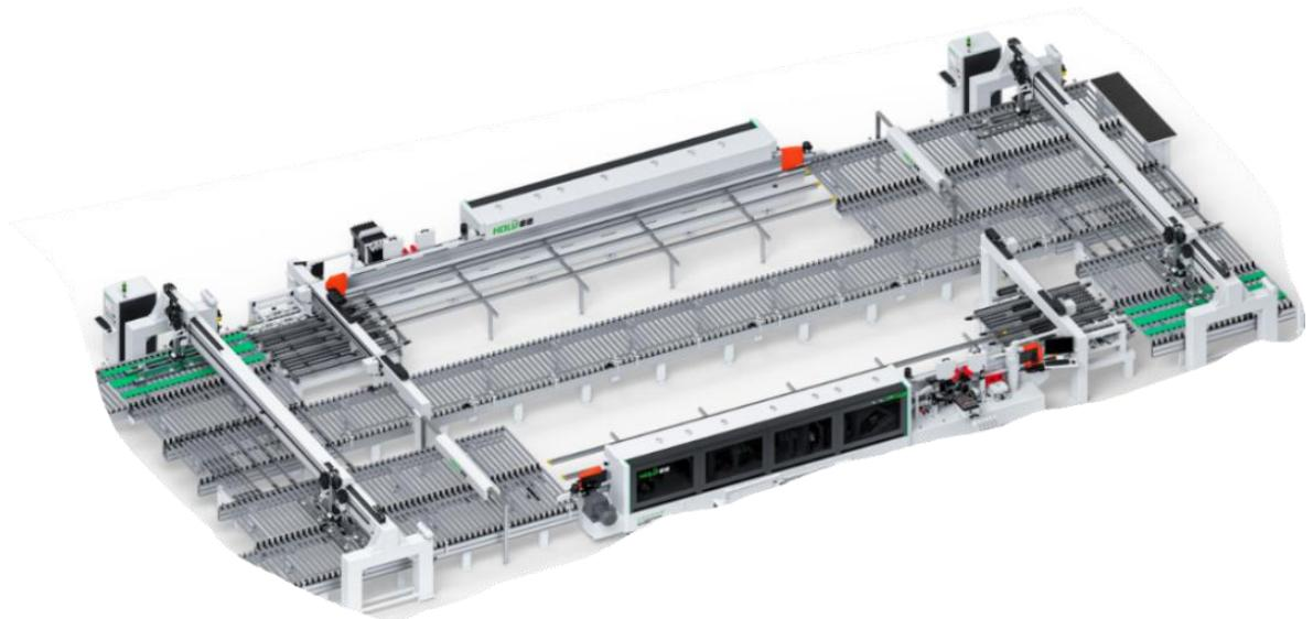
公司的高效封边工作站由两台封边机组成封边回转线，支持多边封边，减少板材翻转和重新定位时间，实现高效精准封边。
