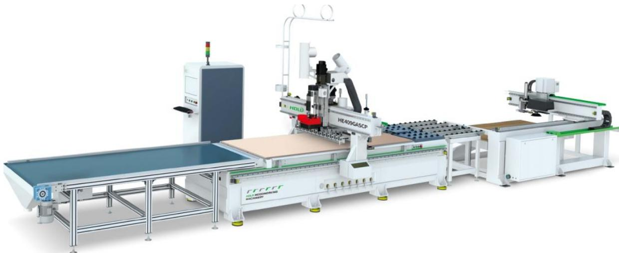
传统开料是通过电子开料锯将一张整板经过纵向、横向裁切成不同规格的板材，适用于板材批量加工。而数控开料机集自动贴标、上料、正面开槽、异形加工、开料和出料于一体，可对板材进行定制化裁剪，适用于全屋定制板材开料。该设备除具有自动抓取、推送板材功能外，还可通过识别标签获取开料加工信息，自动调节加工参数，可实现板材的高效锯切作业。此外，数控开料机还可以多台组合成数控开料工作站，与家具设计拆单软件无缝对接，实现定制家具的自动化、智能化和信息化生产。
