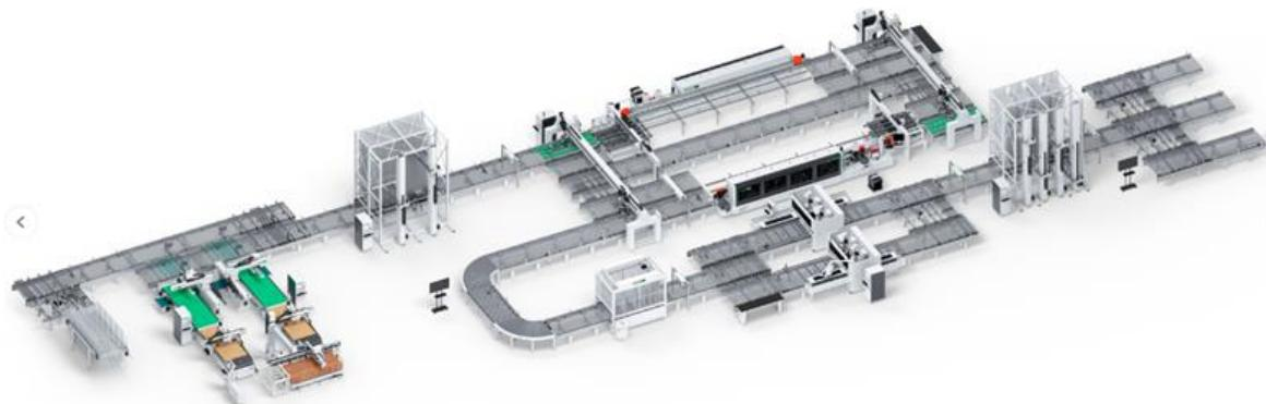
自动化生产线是根据客户生产与物流的精度、位置、轨迹、节拍、稳定性等技术参数和工艺要求，对客户厂区布局、产品工艺、生产流程、产能需求等进行整体规划，通过公司自研的智能软件系统打破了各设备间的“自动化孤岛”现象，显著提高生产车间内部的信息集成水平，实现工件从开料、封边、钻孔、分拣直至包装工段的信息化与智能化；通过公司自研的关键核心设备智能立体缓存仓、智能分拣工作站以及进出料专用机器臂辅助将开料机、封边机或钻孔机等以智能分拣工作站串联起来，实现工件
