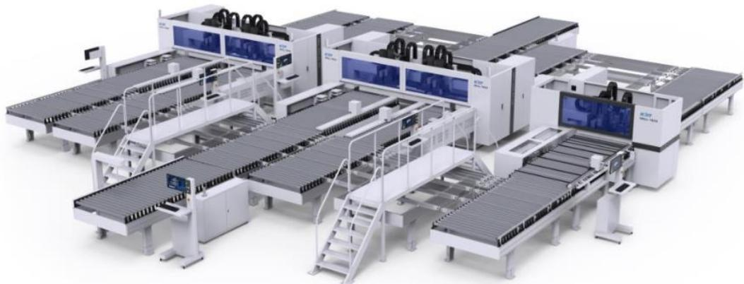
数控钻孔工作站，是由多台六面数控钻孔中心，通过一个进料口和一个出料口，将主机并联的一种钻孔组合，可以与封边工序和分拣工序有效连接。此外，由于具备视觉条码识别、板件尺寸自动检测、加工路径模拟仿真、加工数据统计等多种功能，结合开放式软件对接接口，公司研发的数控钻孔工作站仅需通过扫描板材的标签二维码获取加工信息指令即可自动进行打垂直孔、侧孔、开槽、异型切割等工序，全程无需人工技术性干预，可极大提高加工精度并实现自动化、智能化作业，有效提高生产效率，减少用工成本。
