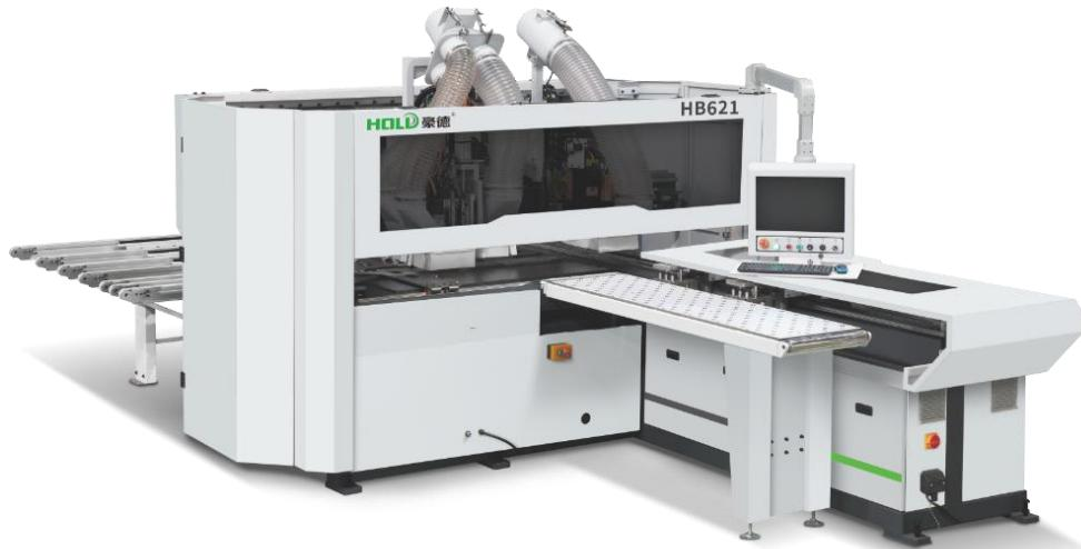
基于定制板式家具加工工艺要求，传统板件钻孔设备在不断适应大批量加工工艺基础上，还要完成多规格、多品类钻孔的加工工序。公司贴合柔性化生产需求开发的五轴六面钻，通过增加旋转主轴，配合六刀库伺服圆盘换刀，可轻松完成各种侧面斜开灯线槽，侧面拉手等工艺造型，满足客户海棠角加工、拉米诺隐形件加工（多角度任意调整）等工艺需求，解决了因传统六面钻无法完成对斜面板材的铣型和
