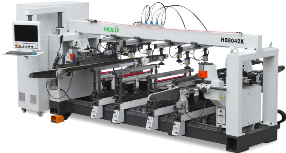
数控自动送料多排钻主要适用于大批量工件钻孔，是一款高效、高自动化的钻孔设备，其采用皮带自动送料装置，上料快速方便，可同时进行板料的底面、顶面和侧面多方向自动钻孔加工作业。
