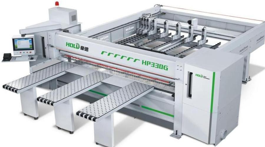
电脑裁板锯是一款采用 PC 控制，可实现人机一体化操作的开料设备，通过在电脑屏幕上输入需要开料的数据，机器可自动完成对板材的精准裁切。公司的数控裁板锯采用先进的电脑控制界面，具有高效率和高精度的特点，可对板料的锯切过程进行实时监测和控制，并可自动优化裁板方案。该设备既能满足全屋定制单张锯切，也能适应批量板材多张叠切，是批量定制家具企业首选产品。
