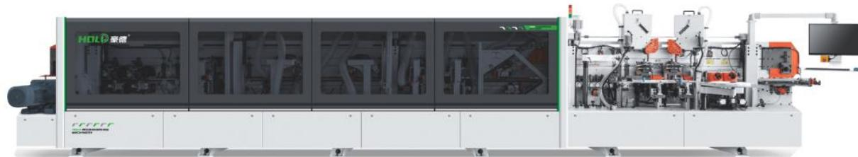
重型全自动高速封边机主要应用于衣柜、橱柜、办公家具等板式家具的封边工序，其利用涂胶辊轮将融化的胶黏剂均匀地涂布在待封边板材的封边部位，再由压辊施加压力将封边条压合在板材的边缘完成封边。重型全自动高速封边机均采用两组快速上溶胶、两组四通道伺服送带、双精修、双刮边、双抛光、高速仿形等功能配置，并且运用高精度定位系统和自动调刀技术调节封边效果，能有效满足柔性化生产的加工需求。
