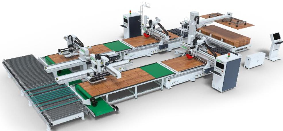
公司的数控开料工作站由一台双贴标头交替式贴标机、两台开料机、两台五轴出料机器臂和带通过式顶升平移机构的输送线、配备余料储存仓和废料输送机构组成，可完成对板式家具的快速精准裁切。
