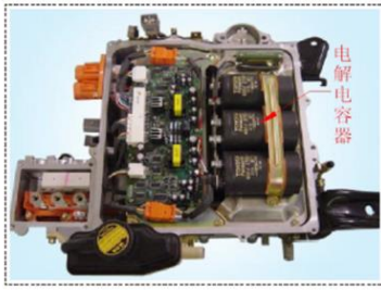
第一代丰田Prius电驱动系统控制器使用电解电容
