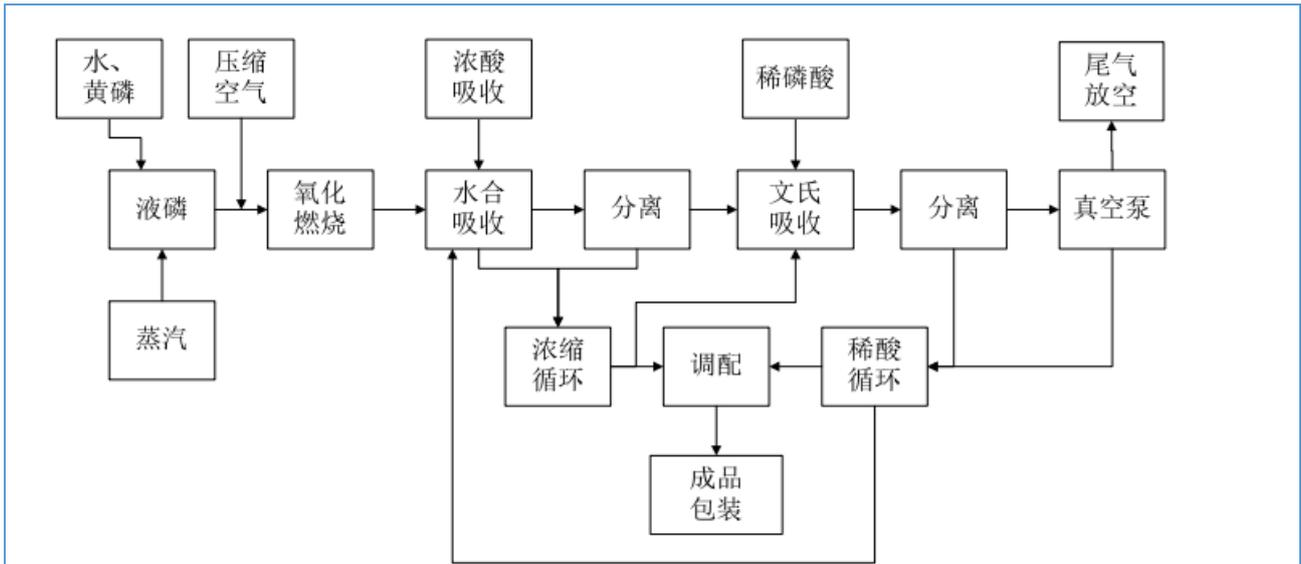
(3) 水溶肥料生产工艺流程
