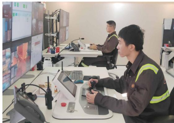
**推动自动化操控技术应用：**公司重视自动化操作技术应用，优化作业环节，减少无效时间，提升设备作业效率，进而降低能源消耗。自主研发的拖车调度管理系统，可实时状态监测、最优路径规划调度，确保码头水平运输环节安全、稳定、高效，被授予深圳首个“5G+ 自动驾驶试点项目”。汕头港 6 台远程自动化轨道吊投产，有效减少人工成本且有效降低了能源消耗。招商港口（华南）散杂货营运中心赤湾港区 6 台门机实现远程操控。湛江港完成 7 台斗轮堆取料机、2 台装船机的智能化远控改造。
