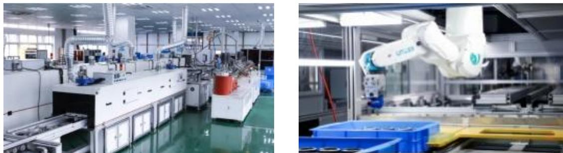
图 4 全自动灌胶线与全自动校验台
