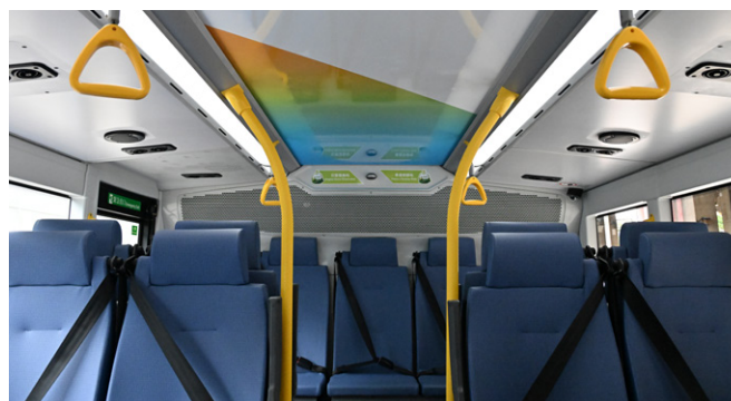
電動巴士上蓋設有太陽能發電板，以供電驅動巴士通風系統（上圖），並全面採用LED燈（下圖）
