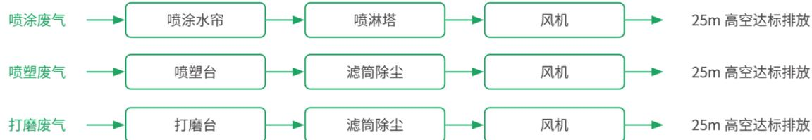
椒江工厂废气处理工艺流程图
