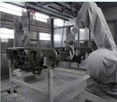
轉向架自動噴塗裝置
