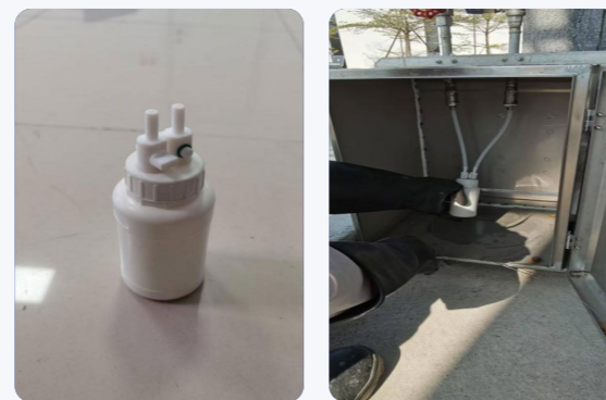
改造後的 NMP 取樣瓶
