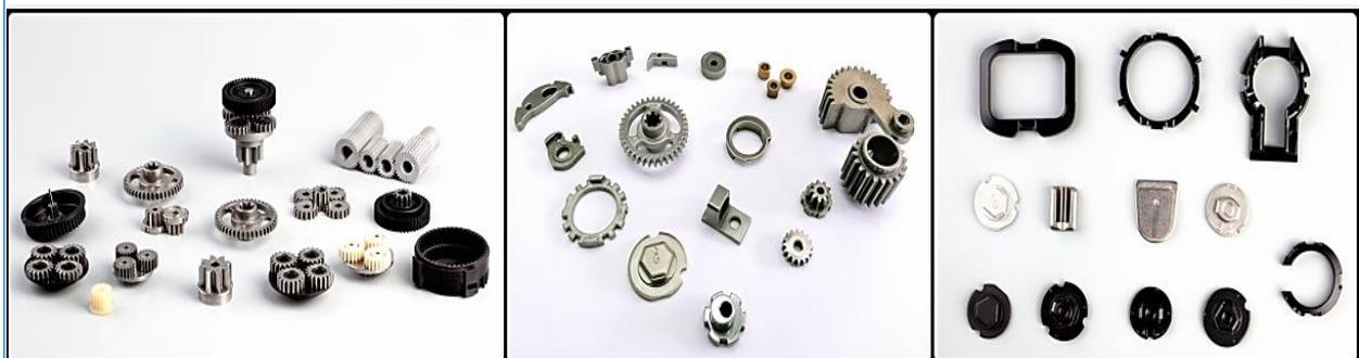
**3、金属粉末注射成形零件（MIM）：**金属粉末注射成形零件是将金属粉末与有机粘结剂在一定温度条件下采用适当的方法混合成均匀的喂料，将粉末状态的喂料加工成一定形状和大小的粒状物后，在加热塑化状态下用注射成形机注入模具型腔内获得成形坯，再经过化学或溶剂脱脂，最后经烧结形成致密的金属零件。金属粉末注射成形零件具有精度高、组织均匀、性能优异、生产成本低
