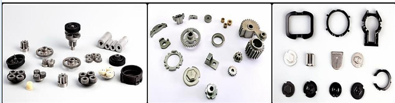
**3、金属粉末注射成形零件（MIM）：**金属粉末注射成形零件是将金属粉末与有机粘结剂在一定温度条件下采用适当的方法混合成均匀的喂料，将粉末状态的喂料加工成一定形状和大小的粒状物后，在加热塑化状态下用注射成形机注入模具型腔内获得成形坯，再经过化学或溶剂脱脂，最后经烧结形成致密
