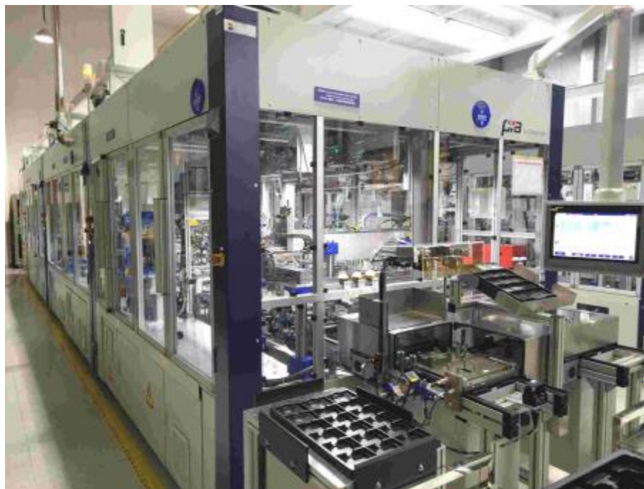
图：4D 毫米波雷达的装配与检测线
