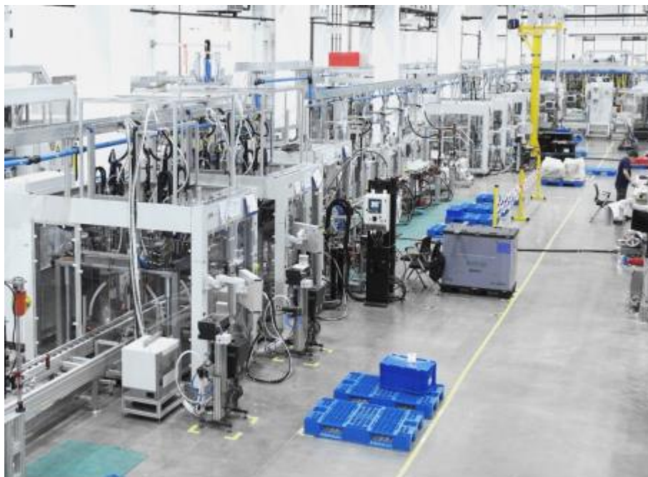
图：三合一电驱的装配和测试系统
