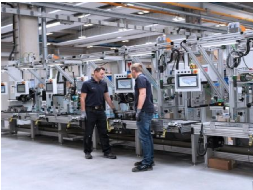
图：800V 变压测试系统
