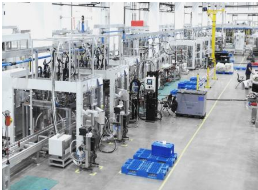
图：三合一电驱的装配和测试系统
