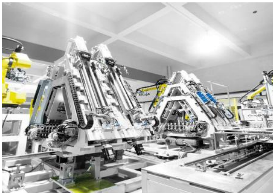
图：动力电池模组智造系统
