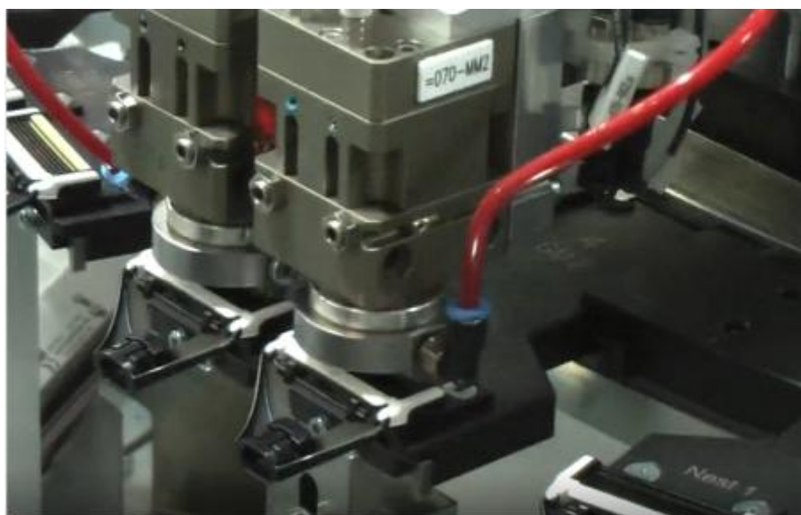
图：湿式剃须刀五层刀头装配线系统
