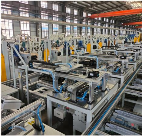
大型铅基铅碳储能电池极板自动化生产线
