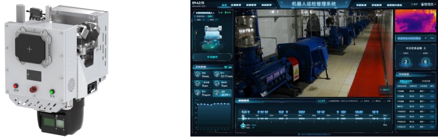
图 3：矿用智能化巡检机器人系统
