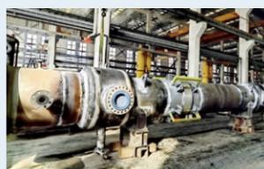
派思设备自主设计制造的首台重型高压掺氢性能加热器在第三方检验公司见证下顺利完成了性能测试及强度试验，各项性能指标均满足设计标准及客户要求。
