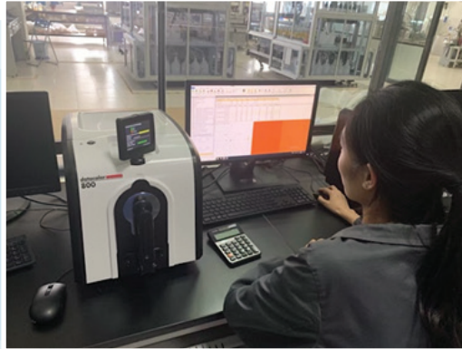
AI Intelligent Colour Matching System — Application of Spectrometer AI智能配色系統 — 分光光譜儀的使用
