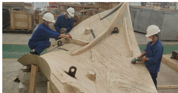
改进大型铸钢件造型方式，工序提效 30%，节约型砂用量约 33m 3 /件
