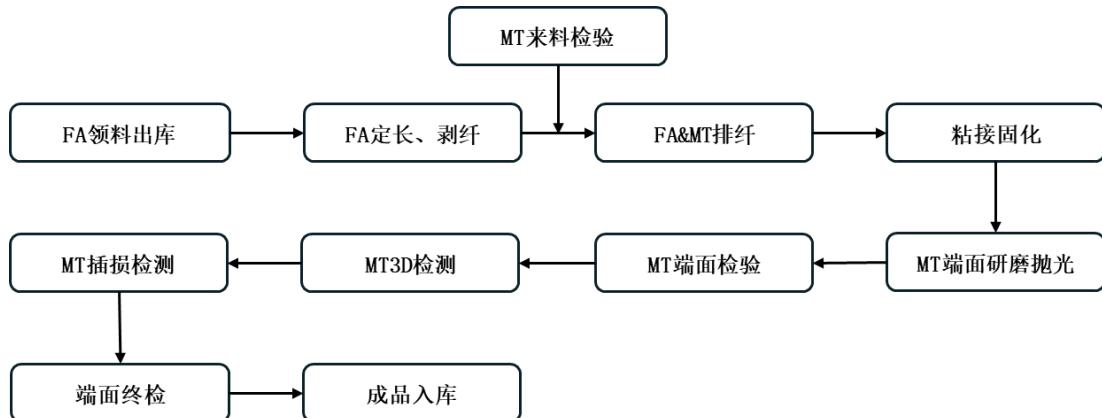
注：FA&MT排纤是指使用显微镜按照工艺图纸将FA多根光纤穿入MT插芯内孔。
