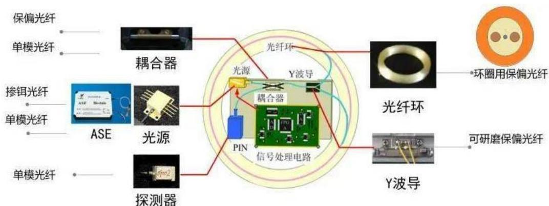
光纤陀螺诞生于1976年，于1994年演化出第二代数字闭环光纤陀螺，也是目前国内外光纤陀螺的主流方案，主要由光源、探测器、耦合器、Y波导、光纤环组件、光信息处理电路等部分构成。随着光子集成芯片技术的飞速发展，新一代光子芯片光纤陀螺应运而生，其通过微纳技术将大部分光学器件、光电器件及电路集成在同一芯片上，实现陀螺的高度集成化，已成为新一代惯性器件的主要发展方向。自2021年至今，国外领先的光纤陀螺制造商（如美国KVH公司、美国Anello公司）已陆续报道研制成功光子芯片光纤陀螺。
