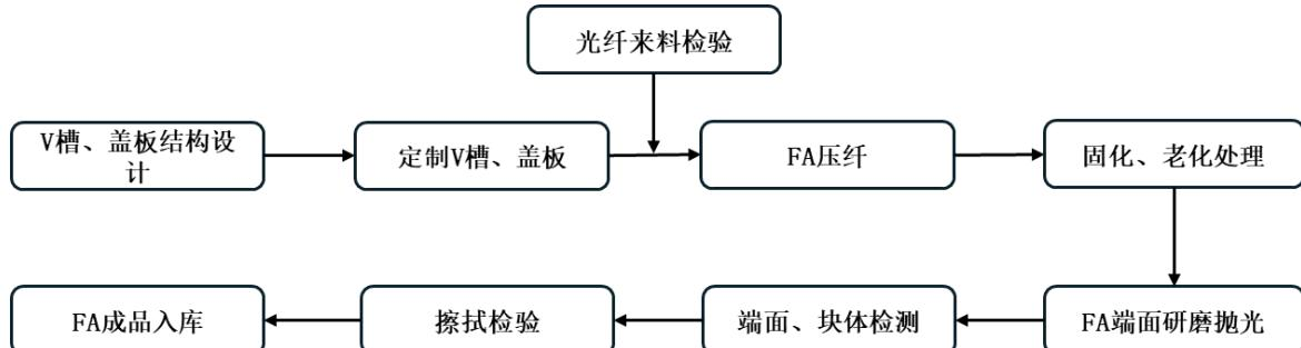
注：FA压纤是指使用工装夹具，将光纤、V槽及盖板按照工艺图纸进行装配。
