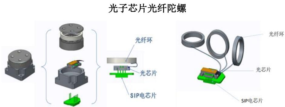
注：左图为单轴光纤陀螺，右图为三轴光纤陀螺，光子芯片光纤陀螺主要由光纤环、光芯片和电芯片组成，其中光纤环与光芯片通过保偏光纤耦合连接。
