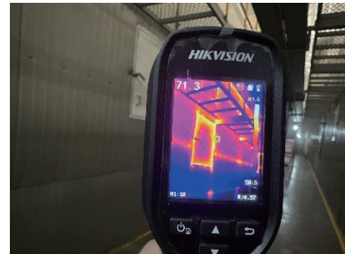
使用热成像仪对烤箱门密封性排查
