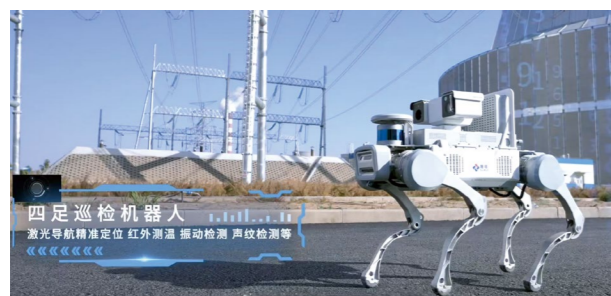
建投准能四足巡检机器人
