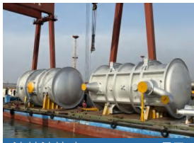
沙特沙比克 PKN MTBE 项目 异丁烷脱氢装置脱氢反应器
