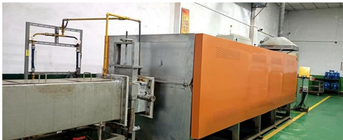
川仪金材分公司改造的连热炉设备
