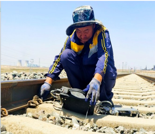
公司探伤工手持焊缝探伤仪对铁轨进行探伤作业
