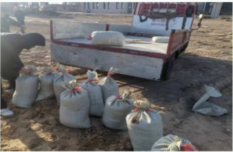
C 组料现场取样
