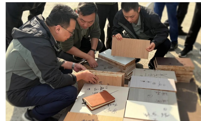
图：兔宝宝对13家供应商样品进行现场裁切锯样，直观地展示了板材的内部结构和质量状况
