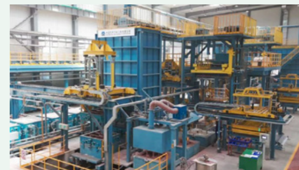
高速 V 法铸造自动生产线
