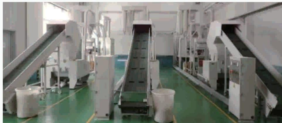
将注塑产生的不良品在粉料房粉碎成塑料粒子回用于注塑机上料区
