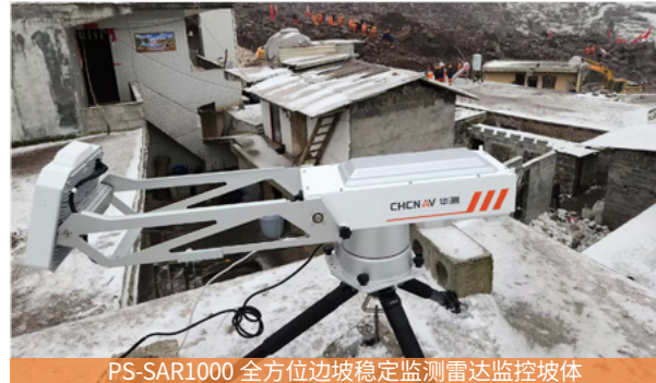
PS-SAR1000 全方位边坡稳定监测雷达监控坡体
