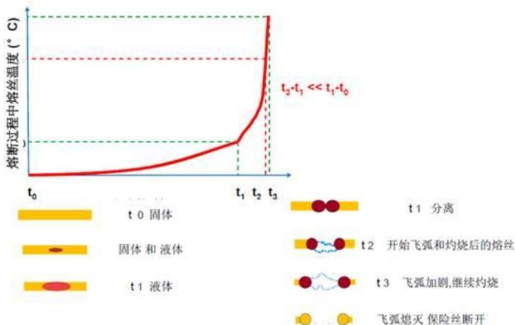
熔断器由于其高分断能力和高可靠性，使其在对电路提供的过电流保护中具有不可替代的作用，具有如下特性：
