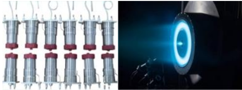
图：霍尔电推进器与公司电推进器核心部件产品
