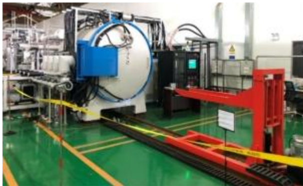
图：公司多功能快速钎焊炉产品
