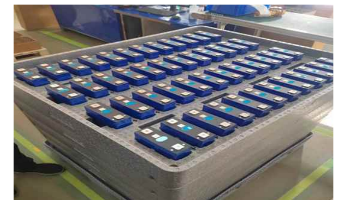
电芯的围板箱+EPP发泡方案
