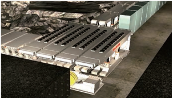
柔模混凝土沿空留巷端头区躲锚支架和采空区挡矸支架工作效果
