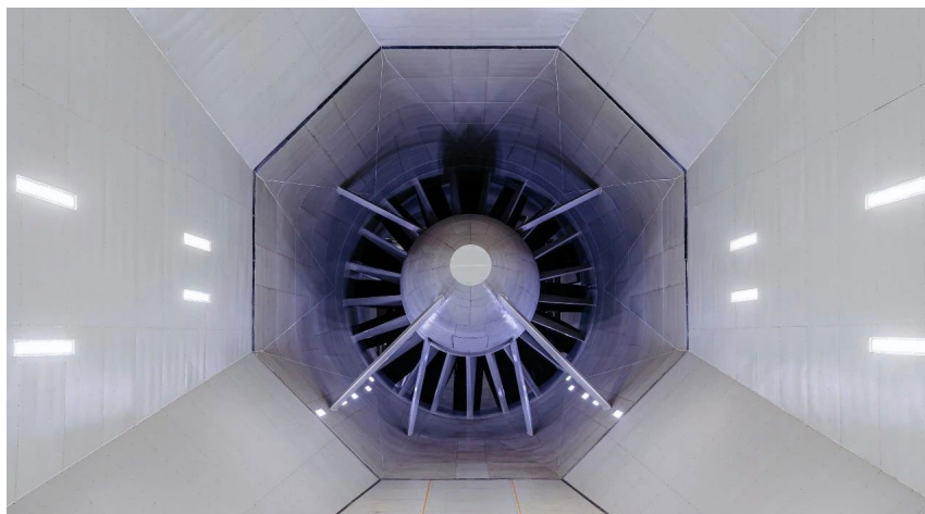
廣汽風洞實驗室主風機系統
