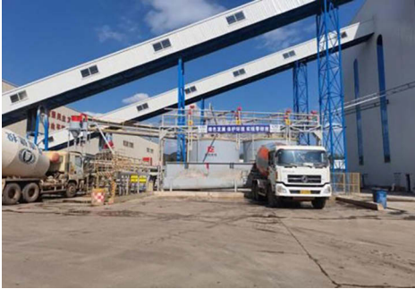
砂石分離+漿水摻配回收系統
